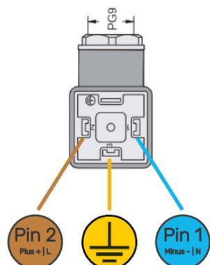
HTC Ventile sind mit einem 3-poligen Ventilstecker Typ A mit PG9-Verschraubung ausgestattet. Der Stecker hat drei Schraubklemmen für L (+), N (-) und Schutzerde (Masse). Durch Drehung des Inneren des Steckers um 90° kann auch die Kabelführung von oben erfolgen.
